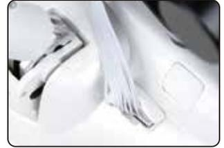
8.4 Schließen Sie das 9PIN weiße Datenkabel am "complex data port" unten am X4 an und verbinden es an der Rückseite des Gimbals.
