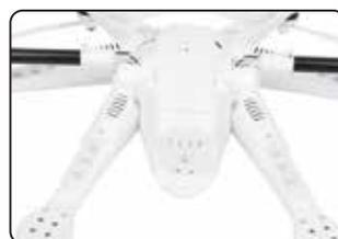
4.1.2 Legen Sie den TALI H500 auf den Rücken mit dem Fahrwerk nach oben zeigend. Das Fahrwerk sollte nicht blockiert werden und frei beweglich sein.
