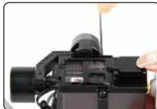
9.3 Installieren Sie die Kamera im Gimbal mit den beiden M2x4 Schrauben so dass die Kameralinse frei bleibt.
