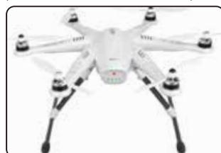
7.6 Halten Sie den Quadrocopter in horizontaler Position und warten ca. 40 Sek. bis die rote LED aufhört zu blinken, die Kalibrierung ist abgeschlossen.
