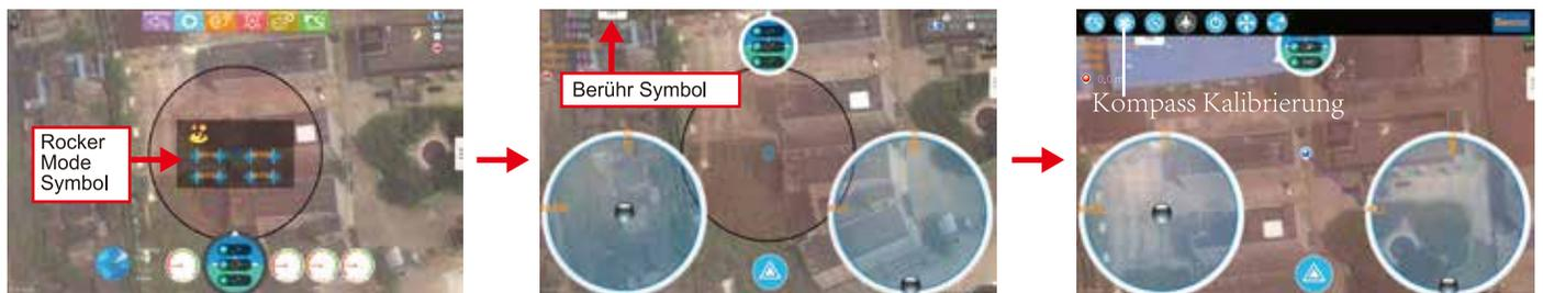
**Wichtig** Stellen Sie sicher das die Motoren vor der Kalibrierung verriegelt sind (Die rote LED des Quadrocopters blinkt nicht). Laut Werkseinstellung sind die Motoren nach erfolgter Bindung nicht verriegelt (Enstsperrern/Sperren der Motoren siehe Punk 10.)
