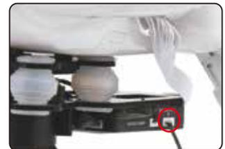
9.4 Schließen Sie das Power Kabel der Kamera an dem Anschluss des G-3D Gimbal an.
