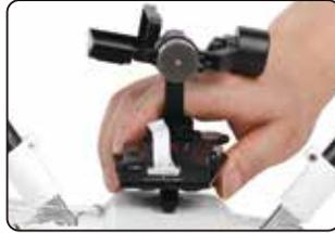
8.2 Schieben Sie den Gimbal in die Schnellbefestigungsschiene von vorne nach hinten komplett ein.
