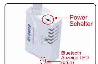
4.1.4 Schalten Sie die 2.4G Bluetooth Verbindung mit dem Power Schalter ein. Das grüne Licht wird schnell blinken und auf die Verbindung mit dem Telefon warten.
